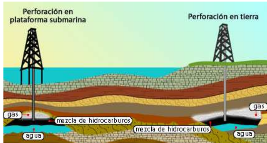
Imagen transversal de un pozo petrolero
